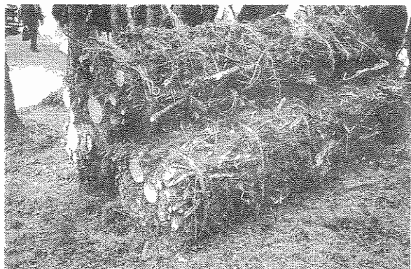
バンドリングマシンによって圧縮・整形された丸太状になった林地残材
