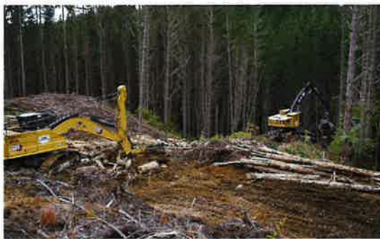
オペレータは牽引されている右下のフェラーバンチャ側にひとりのみで、そこから左上のウインチアシスト（無人）を遠隔制御する。
