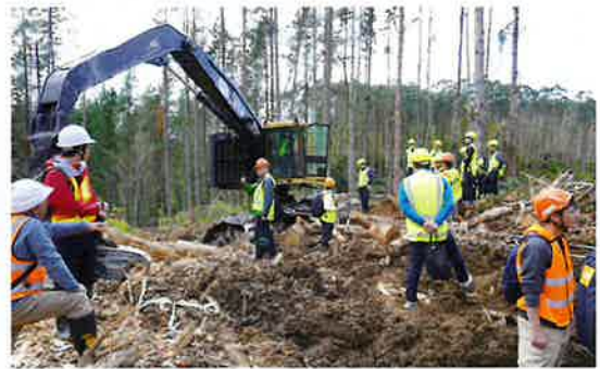
Waratah社のアタッチメントを装着したフェラーバンチャ、ウインチアシストにチェーンで繋がれている。
