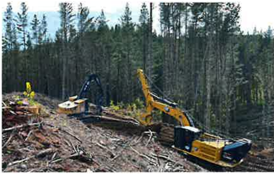
ウインチアシストによる伐採のデモンストレーションを見学。28年生ラジアータ・パイン、生産量は350～400m 3 /日。
