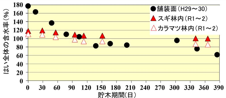
図 貯木場所別のスギ丸太の含水率推移
